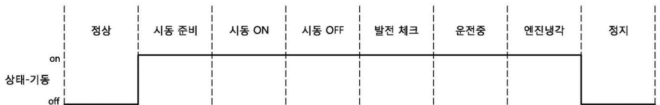
〈 발전기 상태에 따른 [상태-기동] 출력 〉
